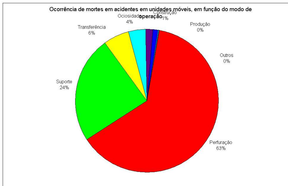
Figura 8.3.5-m - Ocorrência de mortes X modo de operação - dados mundiais p/ unidades móveis - período 1980 / 1993
